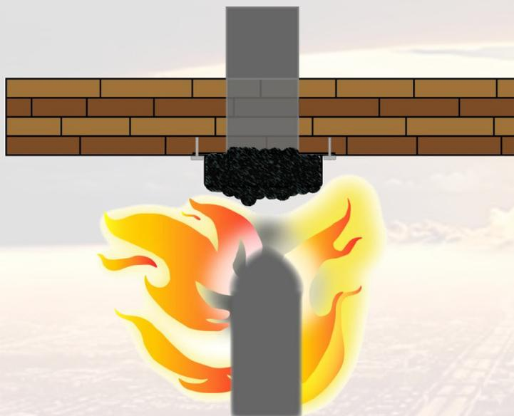
Муфты устанавливаются на пластиковые трубы под перекрытие (например канализацию) и при воздействии температуры, терморасширяющийся вкладыш многократно увеличивается в объеме, образуя плотную пробку.
